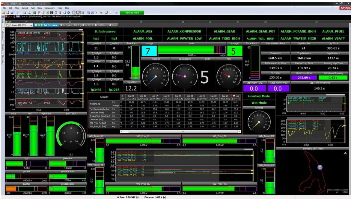
Príloha 7 Ukážka telemetrického systému MoTeC T2 [archiv autora]
