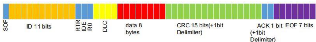
Obrázek 8 Datový rámeček zprávy CAN [21]
