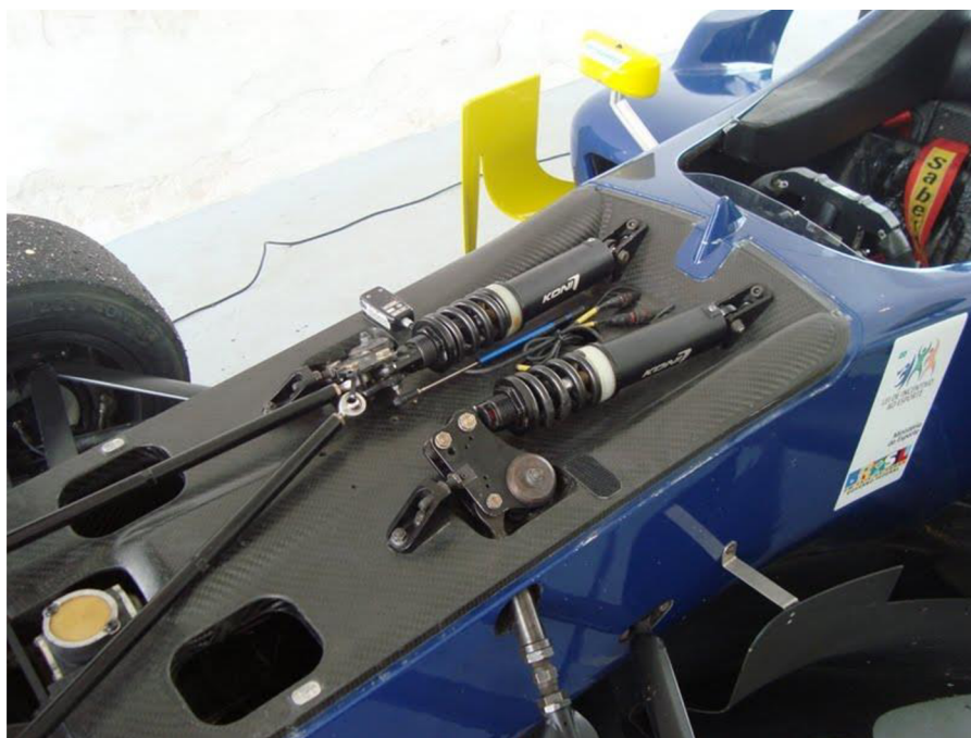
Obrázek 12 Lineární potenciometr tlumičů (modré táhlo) [41]
