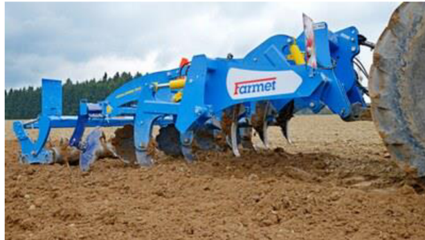
Obr. 30 Systém přizvednutí předních radlic od firmy Farnet [2]
