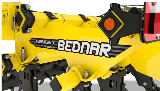
Obr. 19 - Montované provedení rámu firmy Bednar [8]
