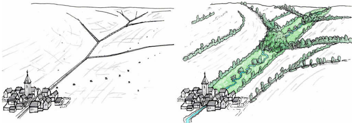
Obr. 7.3.1 Představa nahrazení meliorovaného povodí nad obcí (vlevo) povodím komplexně revitalizovaného (vpravo) (Just et al., 2005)
