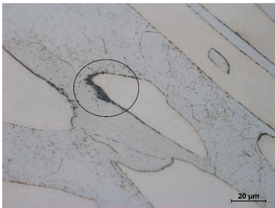
Obr. 4.11 Mikrostruktura (žiháno při 700 °C 4 h, SM).
