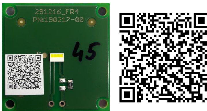
Obrázek 20. Značení testovacích DPS
