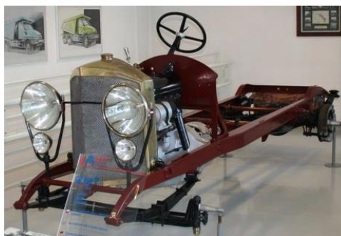
Obrázek 5 Konstrukce vozu Tatra 10
