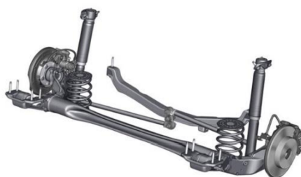
Obrázek 35 Tuhá zadní náprava s Wattovým přímovodem
