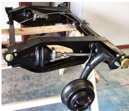
Obrázek 17 Zadní pomocný rám s nezávislým zavěšením kol
