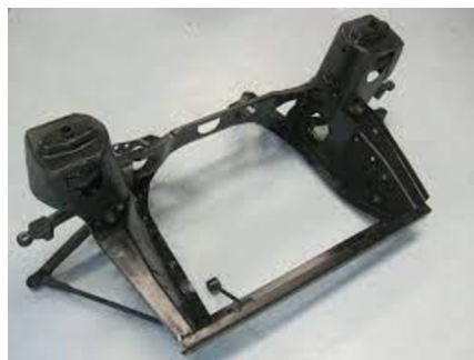
Obrázek 16 Přední pomocný rám s rameny nezávislého zavěšení
