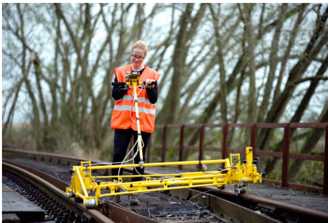
Obr. č. 1 – práce s měřicím vozíkem KRAB. [Zdroj: archiv SŽDC, s.o.]
