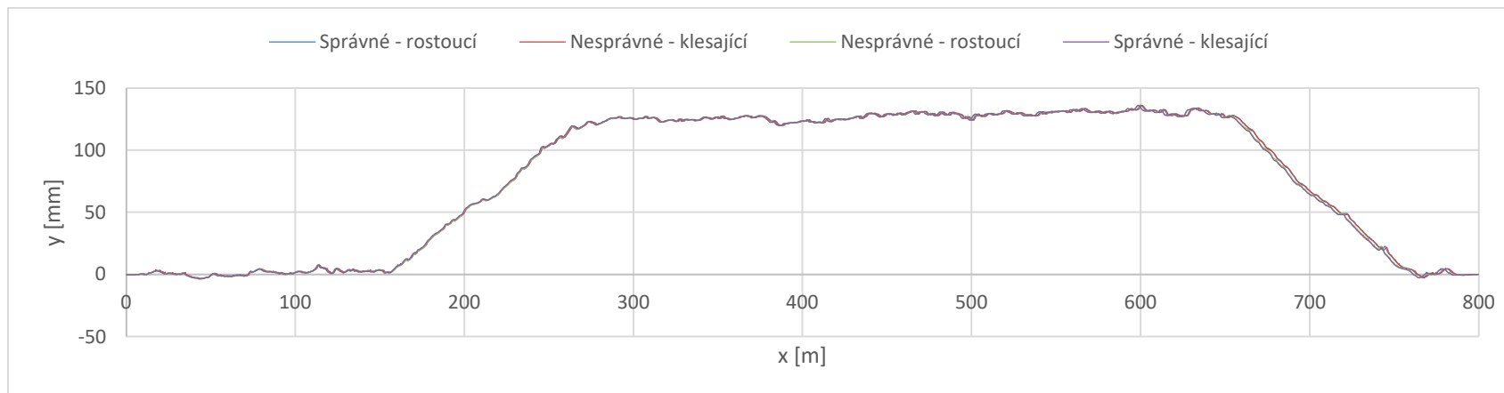
Graf č. 1 – převýšení koleje na úseku 800 m
