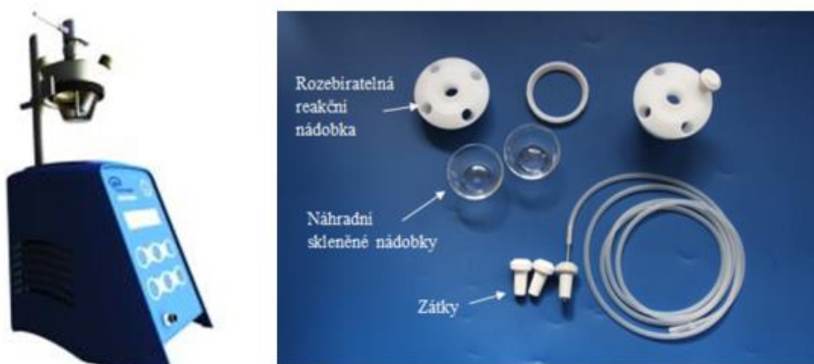
Obrázek 2 Analytický fotobioreaktor AlgaTox, pohled na celou sestavu (vlevo), pohled na rozebiratelnou reakční celu (vpravo) [22]
