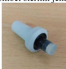
Obrázek 16 Zátka pro transport kapaliny z/do bioreaktoru
