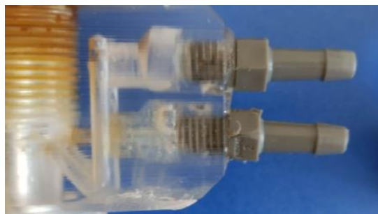
Obrázek 13 Detailní pohled na vstupy pro přívod plynů – interní míchadlo BVT Technologies
