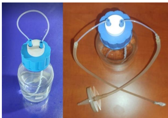
Obrázek 35 Systém pro vlhčení přiváděného vzduchu (vlevo: zásobní láhev s bublačkou a destilovanou vodou – uzavřena pro účely sterilizace horkou parou, vpravo: vysterilizovaná sestava připravená k napojení na minibioreaktor
