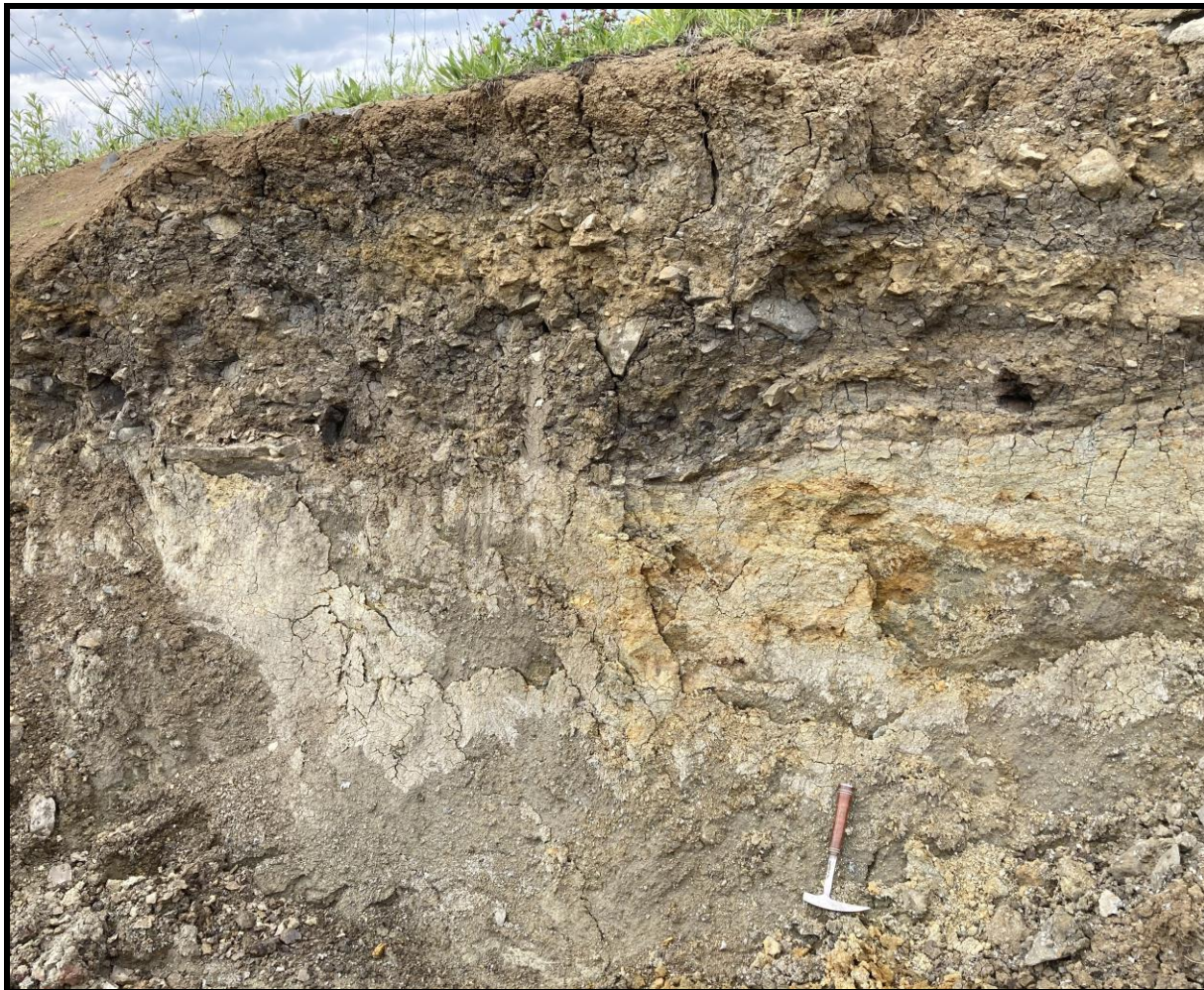
Obr. 9: Odkryv vysoký až 2 m, který je nejvíce tvořen jílem ve spodní části a jílem s úlomky karbonátů a pískovců v části svrchní (lokalita B2).
