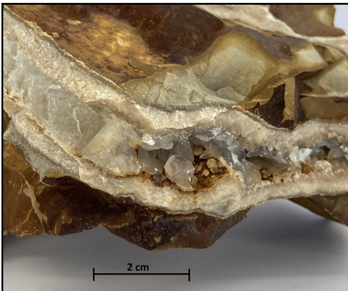
Obr. 13: Detailní zobrazení kalcitové žíly tvořené třemi generacemi kalcitu. První dvě generace jsou tvořeny jemnozrnným tmavě šedým a šedým kalcitem, třetí hrubozrnným čirým kalcitem, který tvoří někdy i cvočkovité krystaly rostoucí do dutiny.
