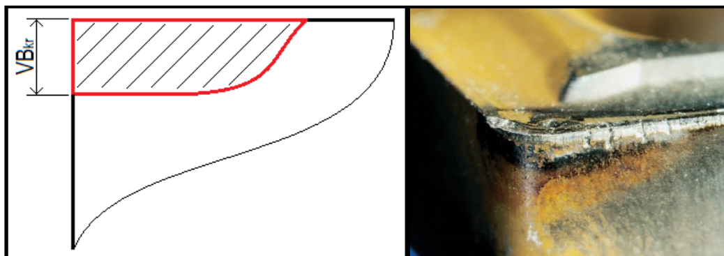
Obr. 4.1 - 5 Měřené opotřebenění VB a příklad reálného opotřebenění [46]
