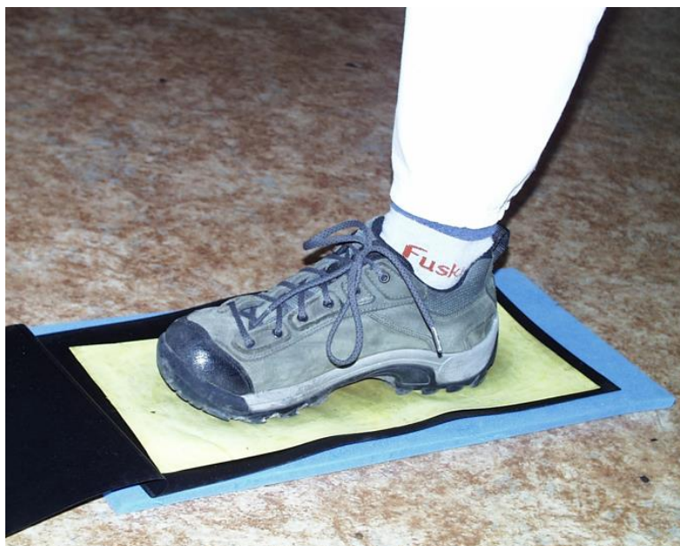
Obr. 29 Snímání kontrolního otisku pomocí soupravy pro nešpinavé snímání kontrolního otisku
