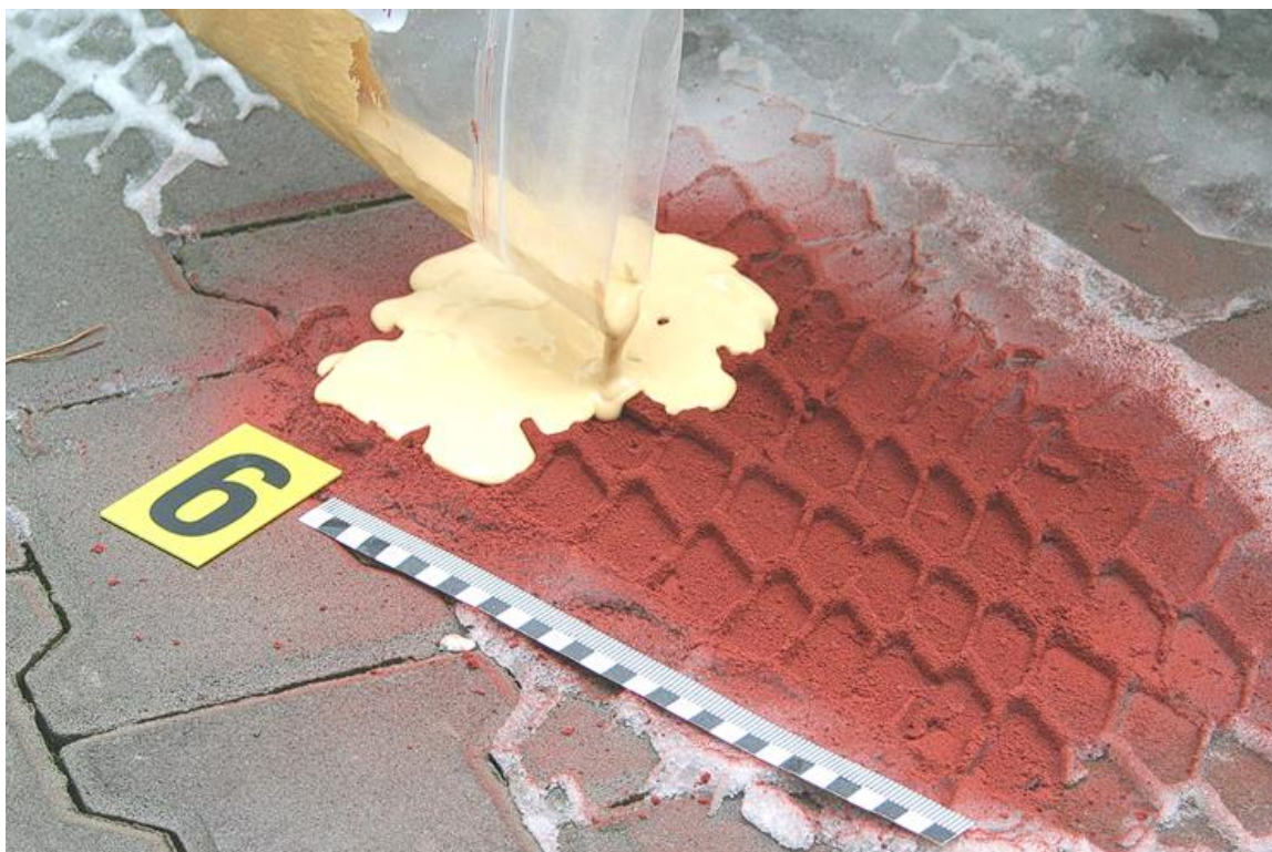
Obr. 14 Odlévání stopy prostředkem Dentalstone Zdroj: Kriminalistický ústav Praha
