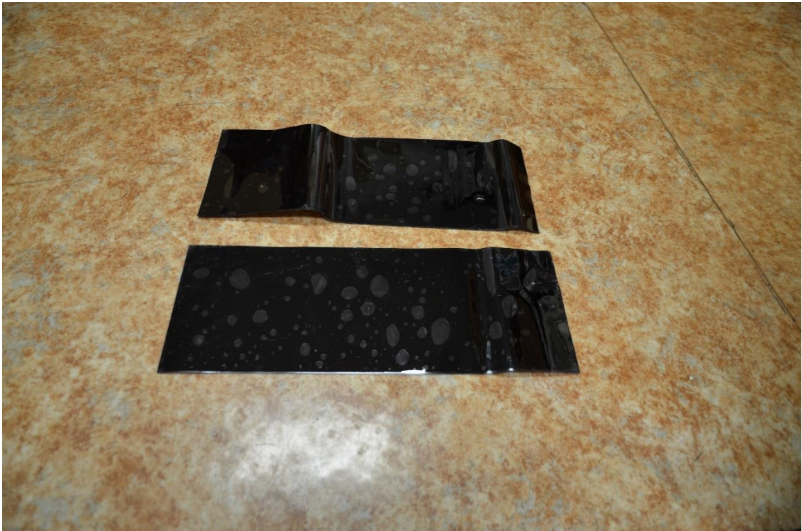
Obr. 16 Špatně přiložená krycí fólie Zdroj: Kriminalistický ústav Praha
