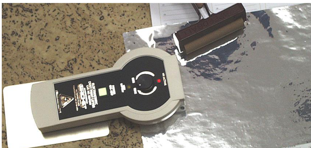
Obr. 13 Použití elektrostatického snímače pro zajištění stopy Zdroj: Kriminalistický ústav Praha
