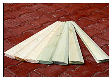
Obr. 5.17 Ručně štípaný šindel (vlevo pro pokládku na rovné plochy, vpravo kónický tvar používaný pro pokládku v rozích, úžlabích apod.)
