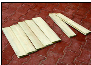
Obr. 5.17 Ručně štípaný šindel (vlevo pro pokládku na rovné plochy, vpravo kónický tvar používaný pro pokládku v rozích, úžlabích apod.)
