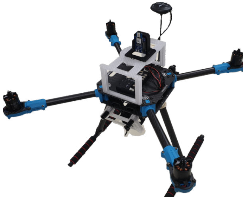
Obr. 3.15: Tag umiestnený na drone
