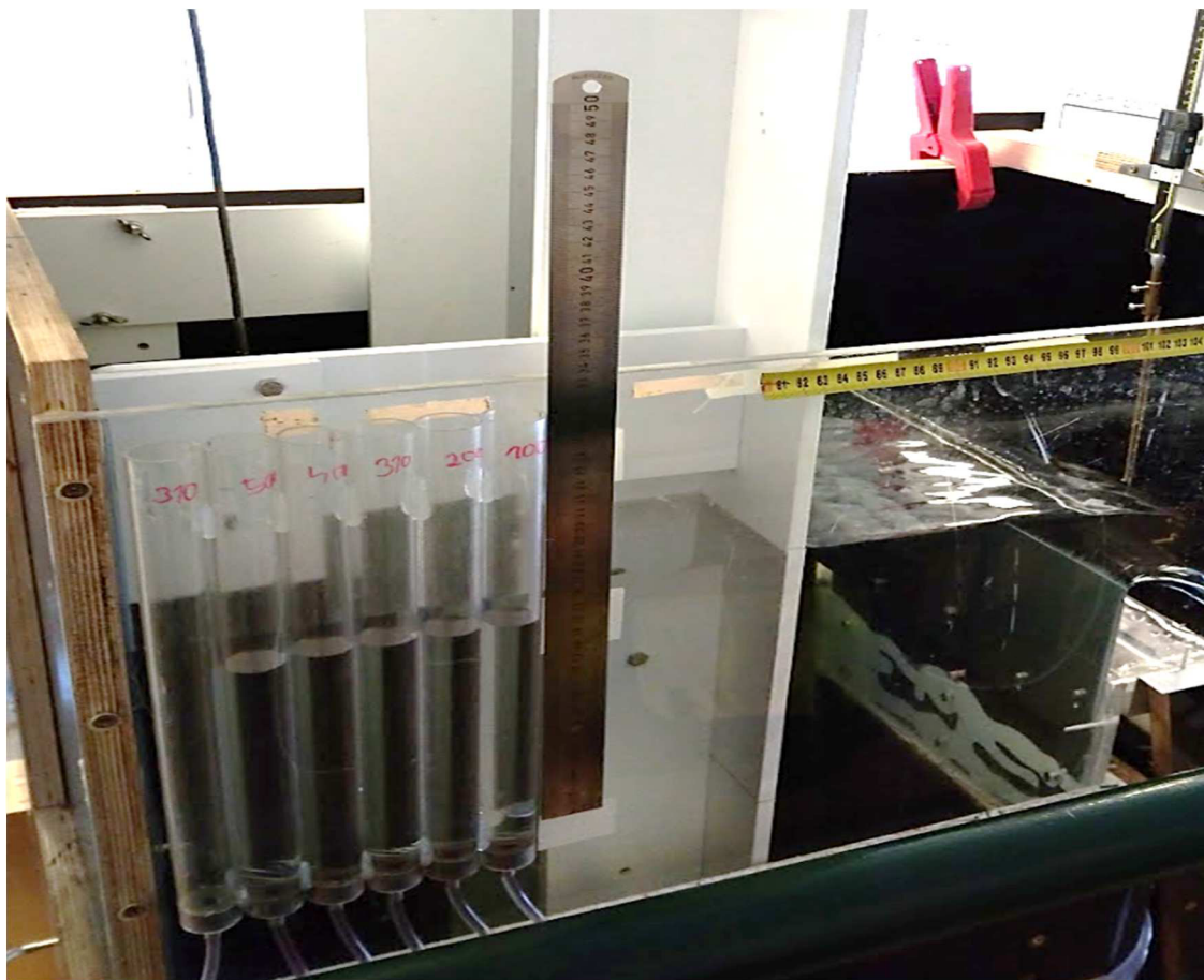
Obr. 4.9 Piezometrické trubice s osazeným ocelovým měřidlem
