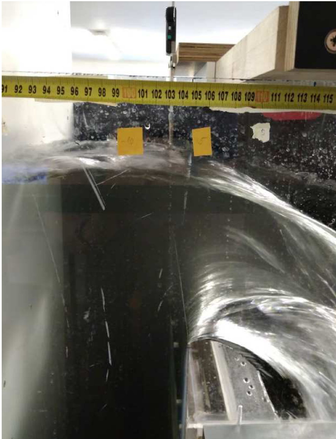
Obr. 4.11 Průběh hladiny při L = 0,2 \text{ m} a Q = 0,06 \text{ m}^3/\text{s}
