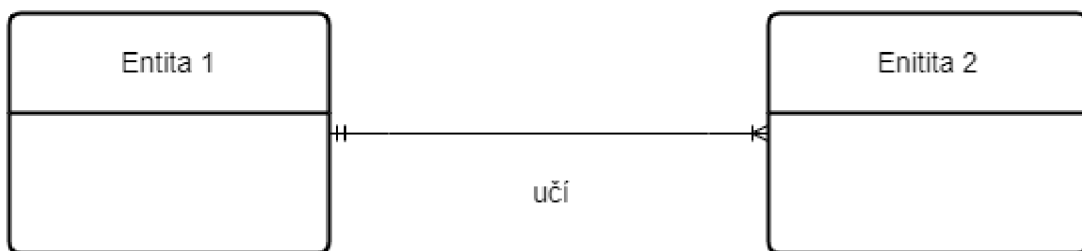
Obrázok č. 15: Prvý typ relácie 1:M zobrazený notáciou Crow's Foot (Zdroj: Vlastné spracovanie podľa (8))
