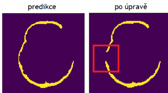
Obr. 6.8: Ukázka výstupu kombinace mediánového filtru a aktivních kontur aplikované na predikovaná data. V červeném rámečku je označena oblast, ve které došlo ke ztrátě nemalé části lebeční kosti.
