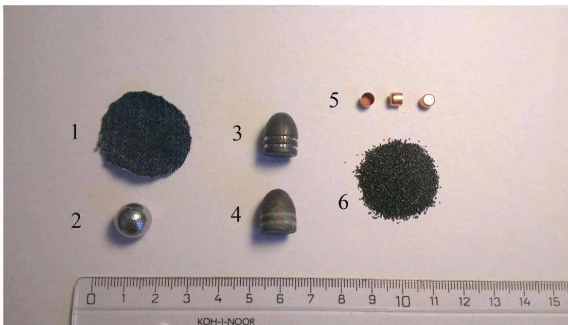
1 - maštná látková vložka („flastr“), 2 - sférický projektil, 3 - ogivální projektil, 4 - ogivální projektil s vyplněnými drážkami lubrikantem, 5 - perkusní zápalka ve všech pohledech, 6 - odměřená prachová nálož
