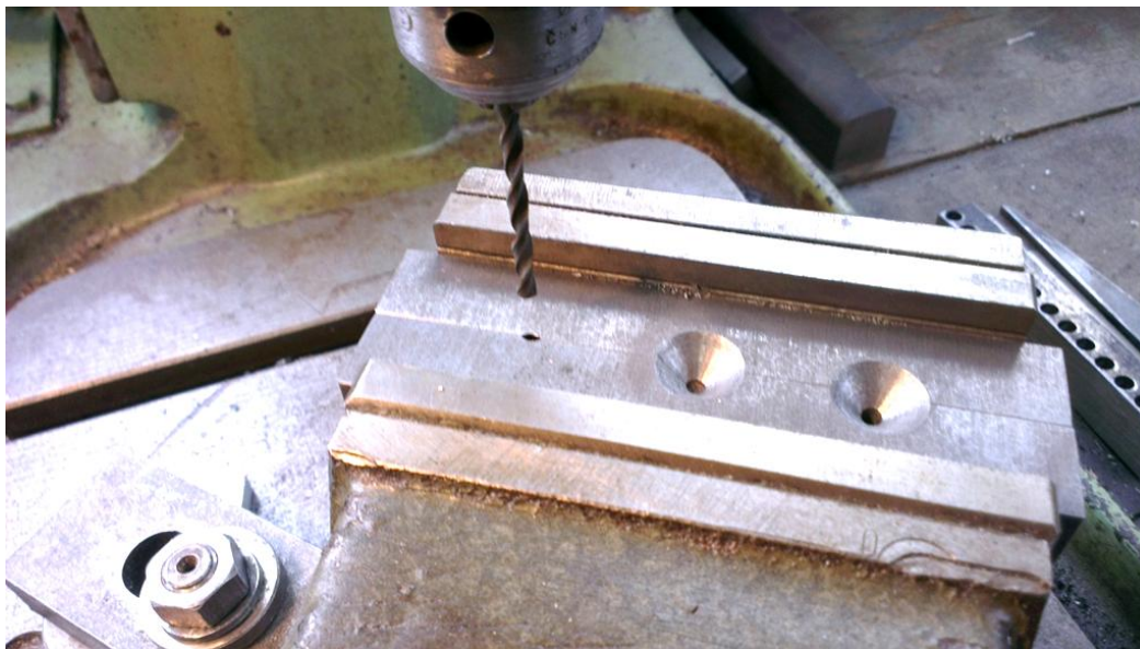
Obr. 3.10 Vrtání vtokové díry.
