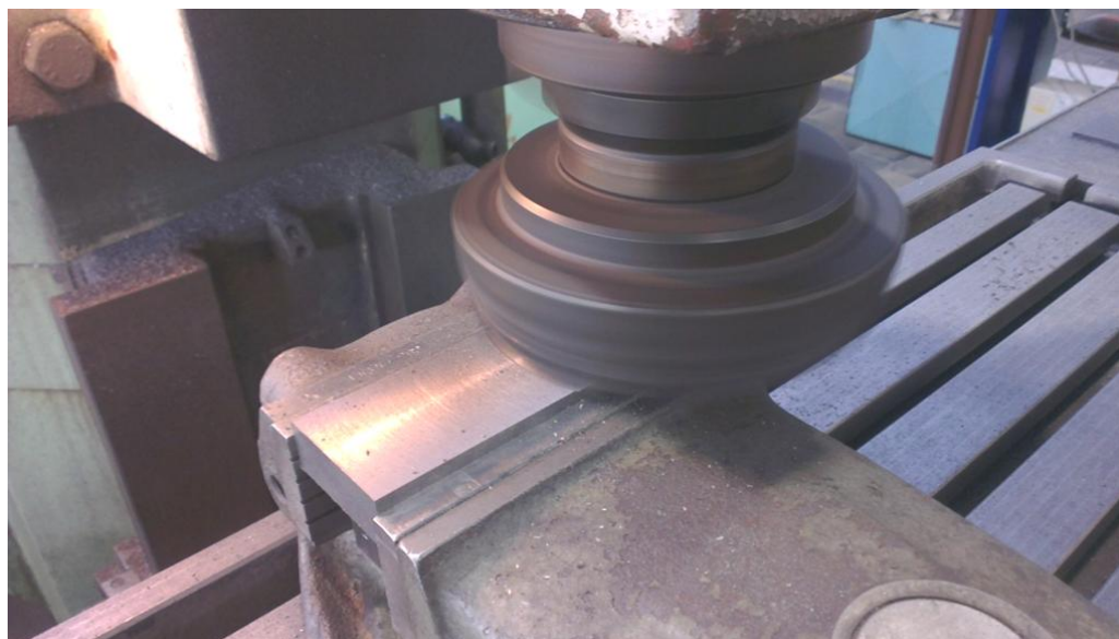
Obr. 3.1 Úhlování na frézce.
