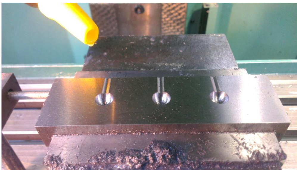
Obr. 3.7 Vodicí drážky pro vrtání.
