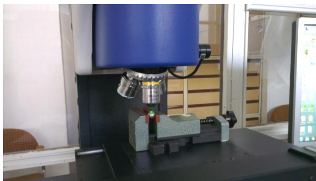
Obr. 4.3 Zkoumání povrchu projektilu na profilometru Talysurf CCI Lite.
