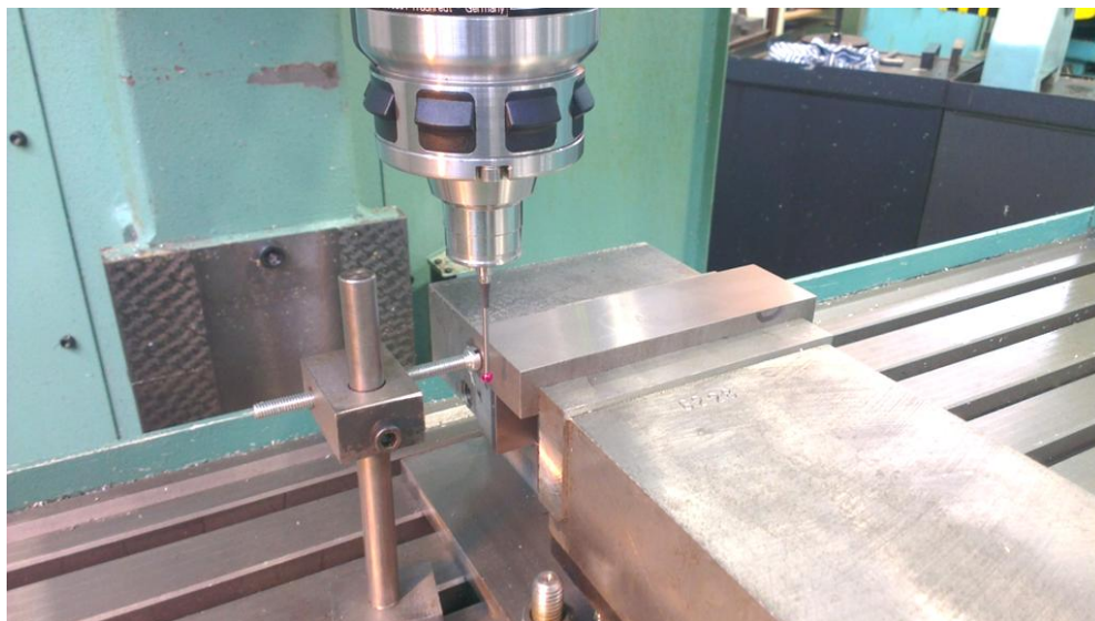
Obr. 3.4 Seřízení stroje pomocí dotykové sondy.
