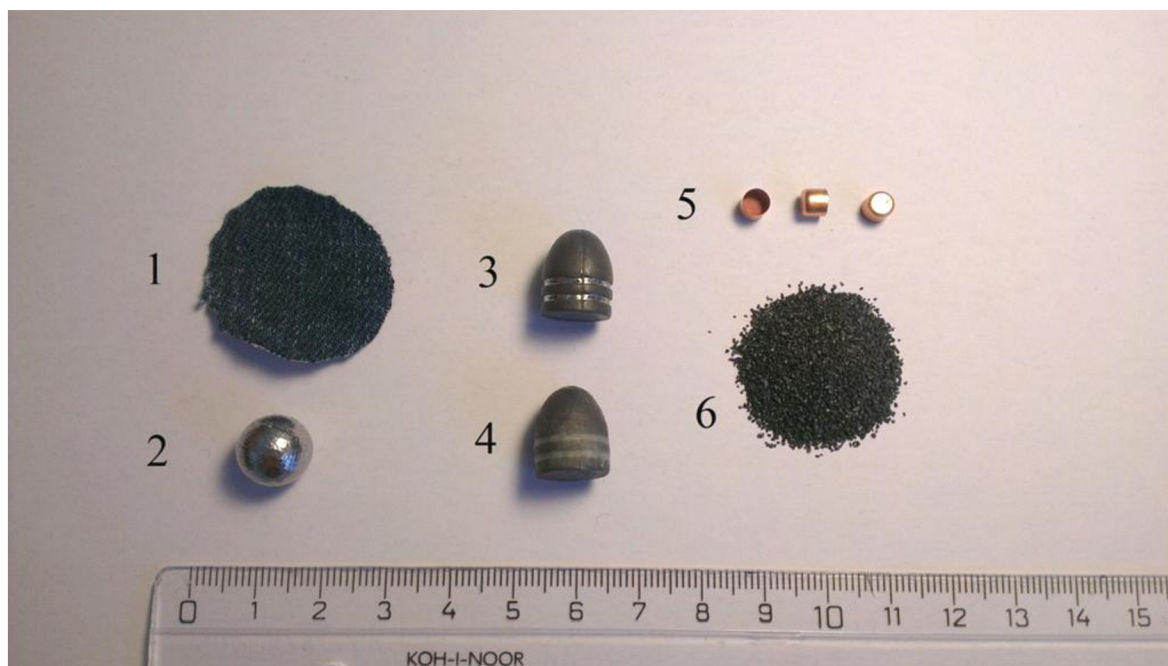
1 - maštěná látková vložka („flastr“), 2 - sférický projektil, 3 - ogivální projektil, 4 - ogivální projektil s vyplněnými drážkami lubrikantem, 5 - perkusní zápalka ve všech pohledech, 6 - odměřená prachová nálož
