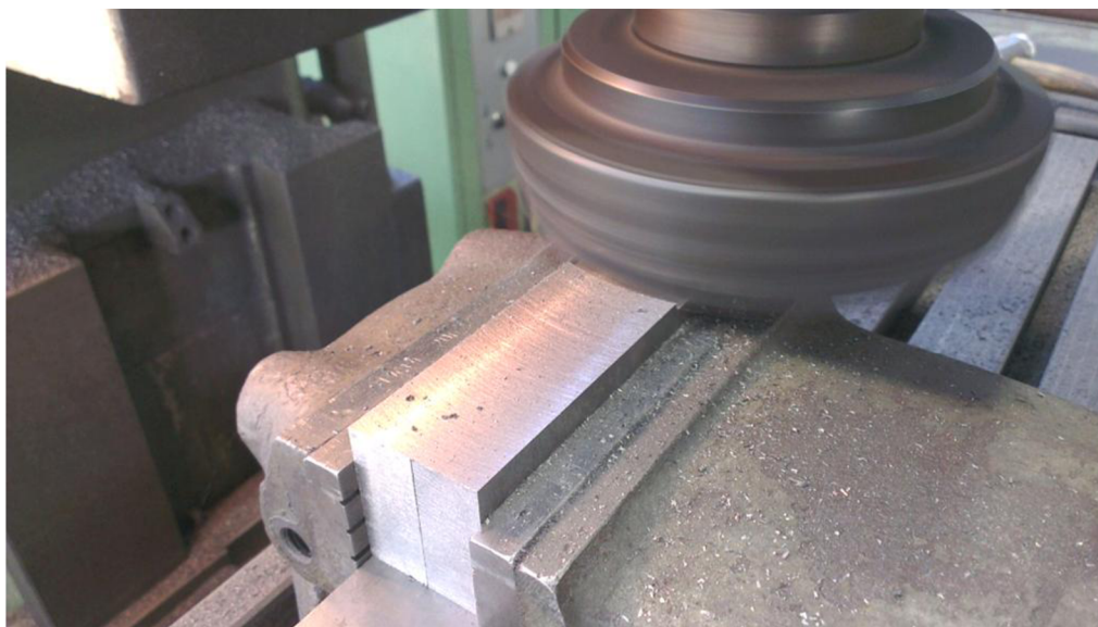
Obr. 3.2 Frézování dvou kusů zároveň.
