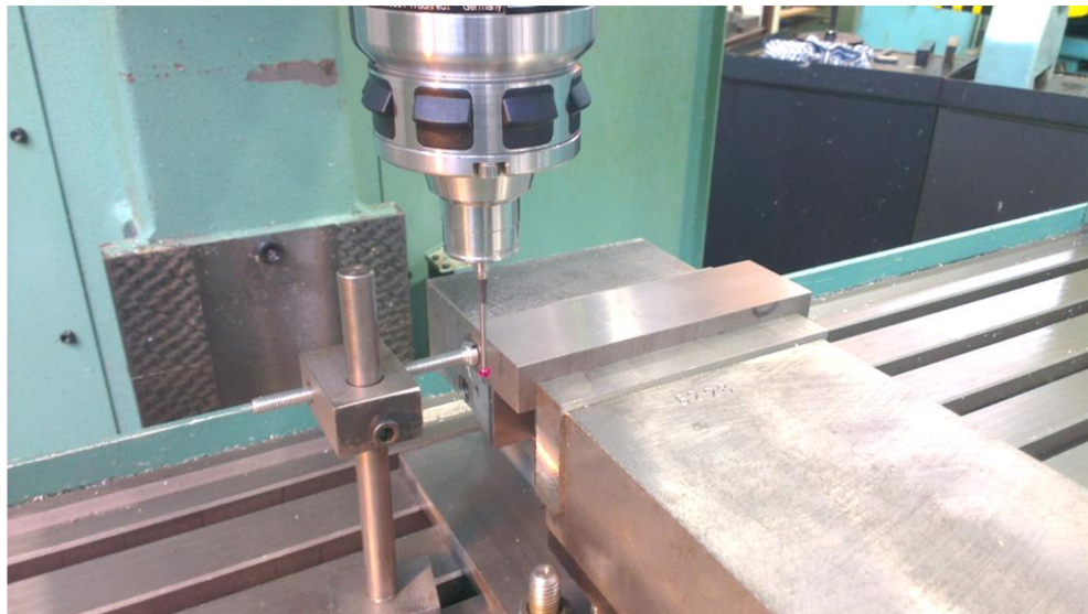
Obr. 3.4 Seřízení stroje pomocí dotykové sondy.
