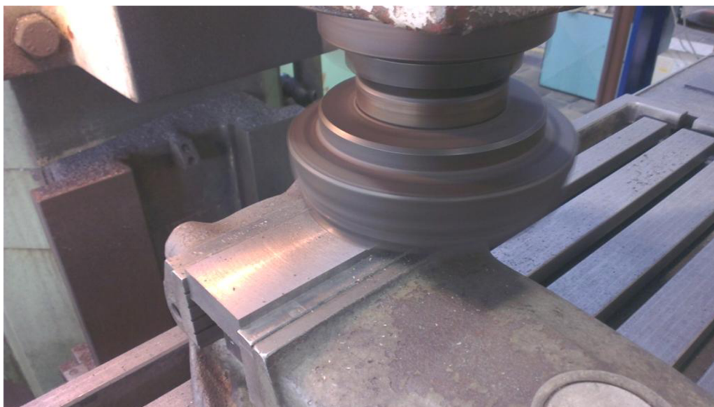
Obr. 3.1 Úhlování na frézce.
