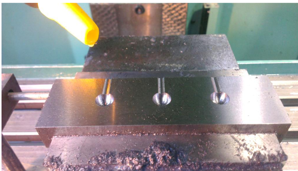
Obr. 3.7 Vodící drážky pro vrtání.
