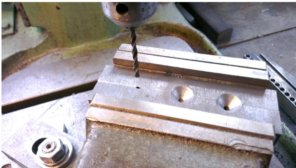
Obr. 3.10 Vrtání vtokové díry.
