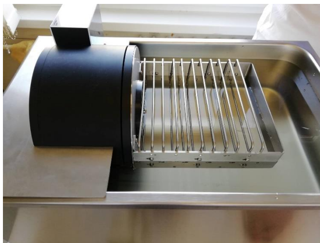
Obr.19: Chandlerova smyčka (Chandler loop system, ebo kunze, Neuffen, Německo).
