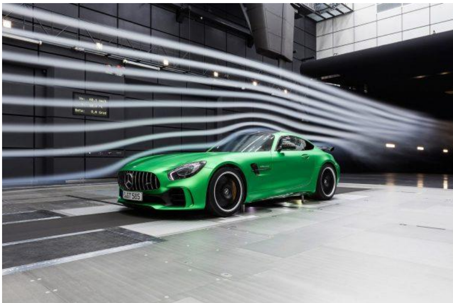
Obr. 26 - Kouřová metoda – Mercedes Benz AMG GT R [19]
