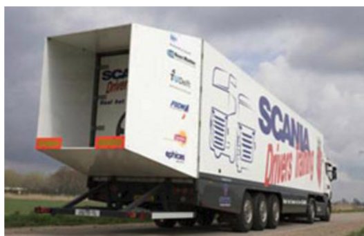
Obr. 22 - Zúžení zadní části návěsu [16]
