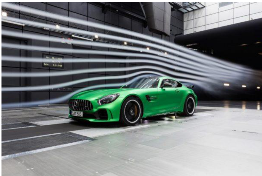
Obr. 26 - Kouřová metoda – Mercedes Benz AMG GT R [19]
