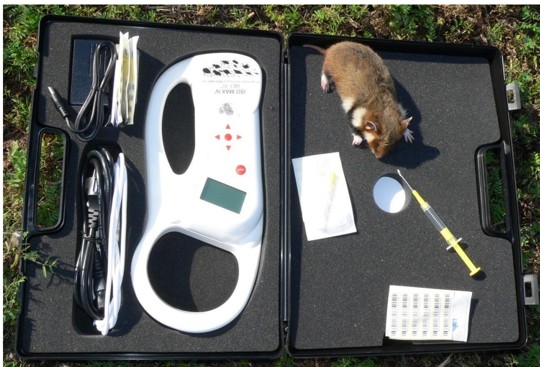
Obr. 6 Čtečka čipů (vlevo) a injekční souprava pro zavádění transponderů (vpravo)
