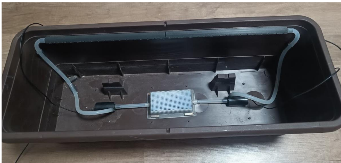
Obrázek 38 - Zapojený vodní okruh
