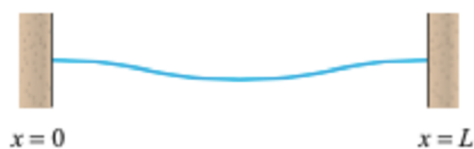
Obrázek 3.2: Vetknutý na obou koncích
