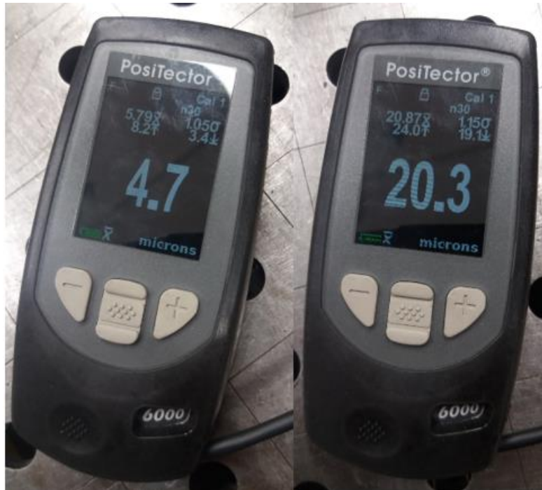
Obr. 32 Tloušťky povlaku zinky pro galvanický povlak (vlevo) a žárový (vpravo)
