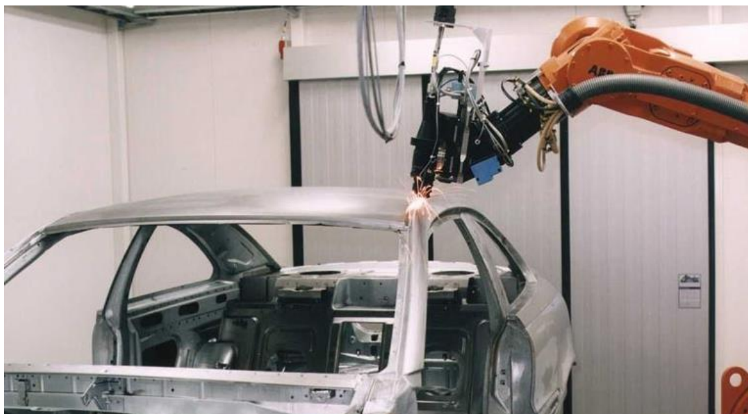
Obr. 1 Svařování karoserie laserem [1]
