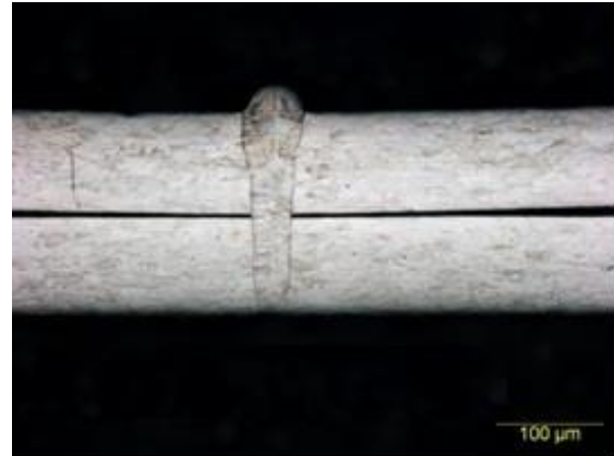
Obr. 12 Tvar svaru při penetračním módu [28]
