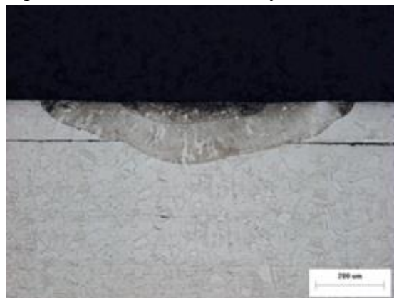
Obr. 11 Tvar svaru při kondukčním módu [28]
