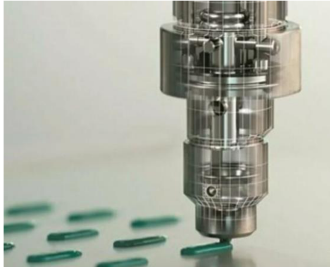
Obr. 6 Strojní nanášení lepidla [9]
