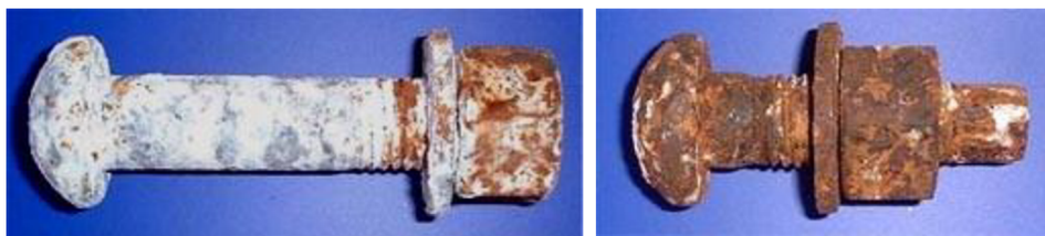
Obr.10 Vzorky po 1500 h v solné mlze (žárové zinkování vlevo, galvanické vpravo) [26]
