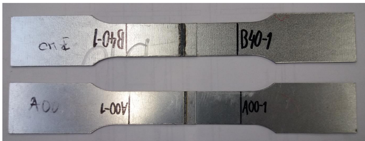
Obr. 38 Zkušební vzorky pro tahovou zkoušku
