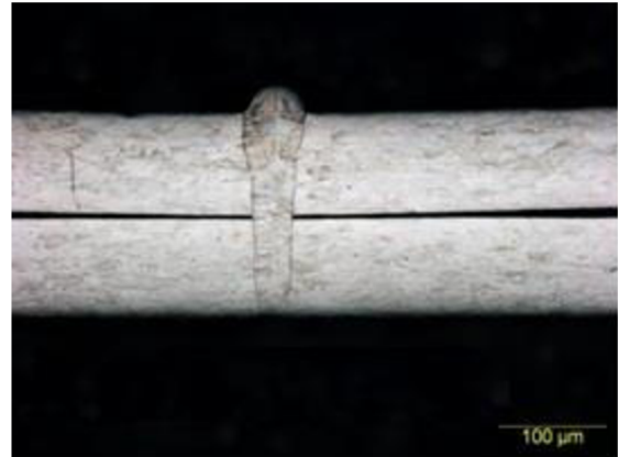
Obr. 12 Tvar svaru při penetračním módu [28]
