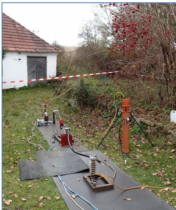
Obr. 9-7 Místo zemního spojení v DTS Kočí
