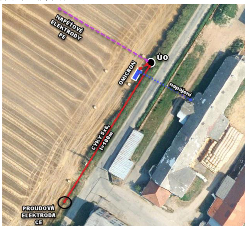
Obr. 9-11 Rozmístění testovacích elektrod a měřicího přístroje (Zdroj: www.mapy.cz )
