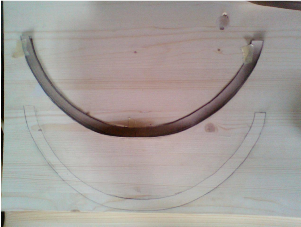
Obr. 9: Nákres konstrukčních prvků na materiál
