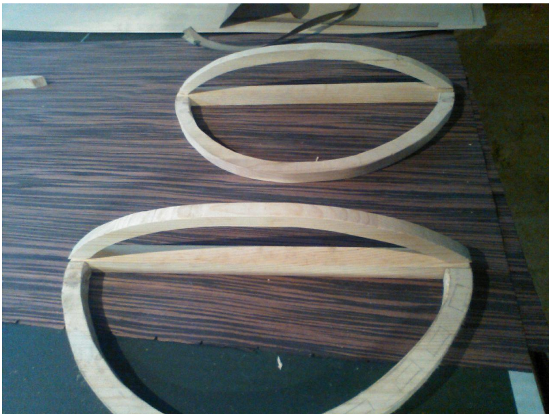
Obr. 11: Protilehlé boční konstrukce před spojením
