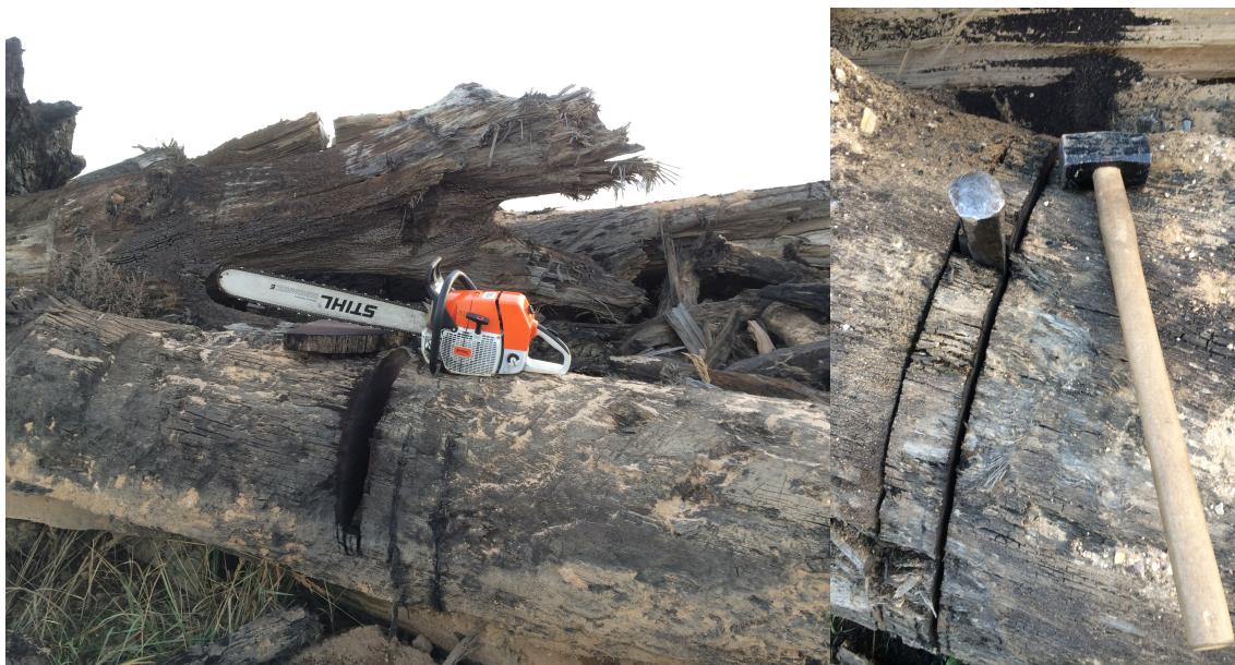
Obr. 9, 10: Odběr vzorků pomocí motorové pily, železné palice a železného klínu
