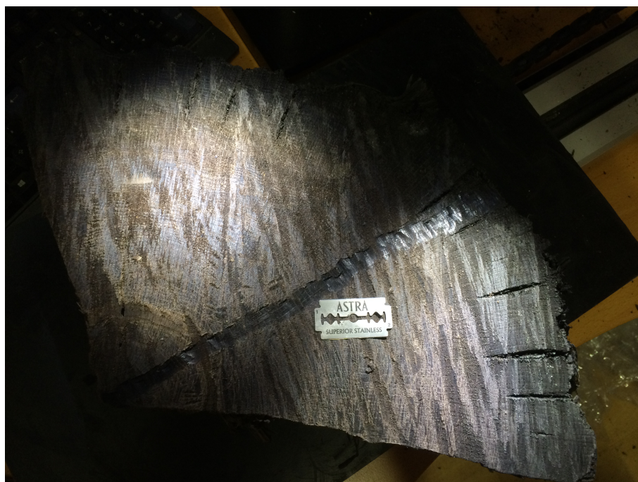
Obr. 13: Vzorek subfossilního dubu s vyříznutou cestou pro měření
