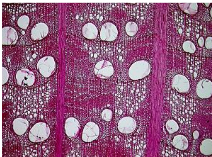
Obr. 2: Příčný mikroskopický řez dubu (Vavrčík a kol., 2002)
