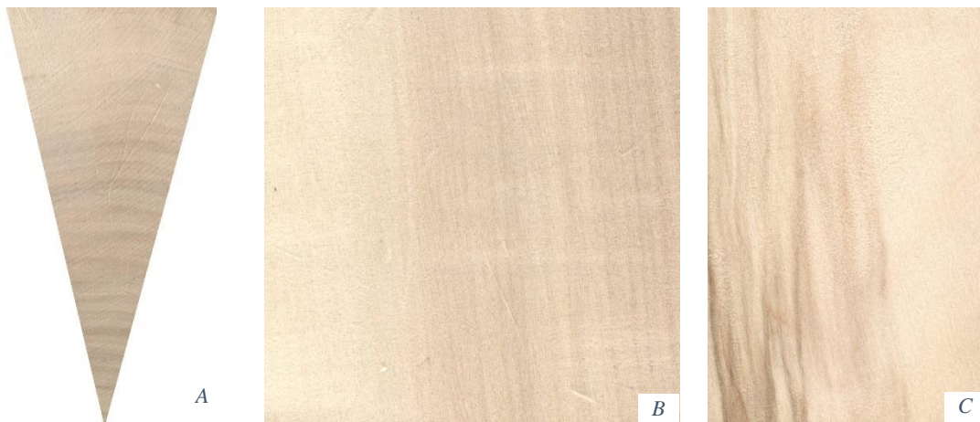
Obrázek 1 – Makroskopická stavba dřeva topolu osiky: A – příčný řez; B – radiální řez; C – tangenciální řez
