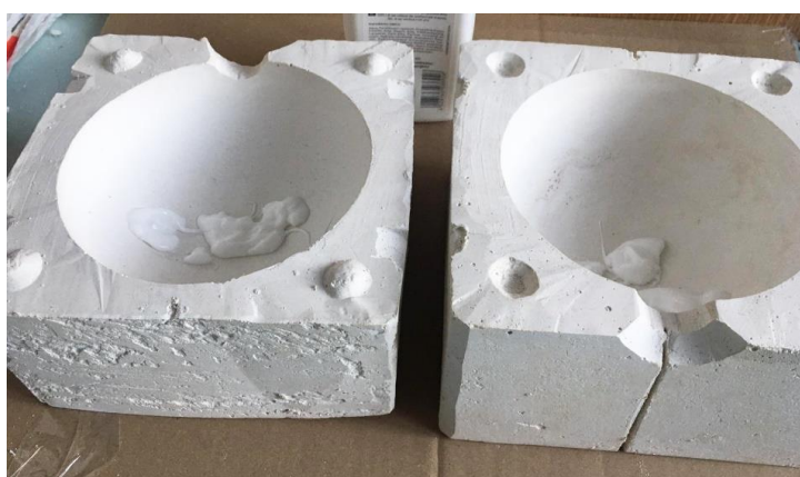
Obr. 133 Vymazání formy Indulonou
