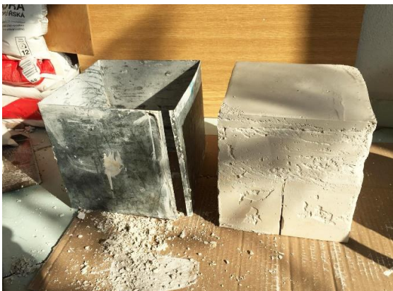
Obr. 129 Odstranění plechového obalu
