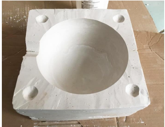
Obr. 126 Polohovací zámký a polovina nalévacího vtoku
