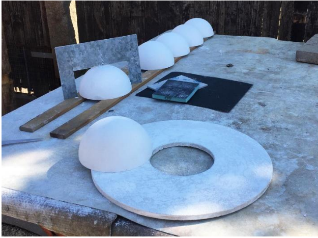
Obr. 140, Obr. 141 Broušení polokoulí na brusném kameni
