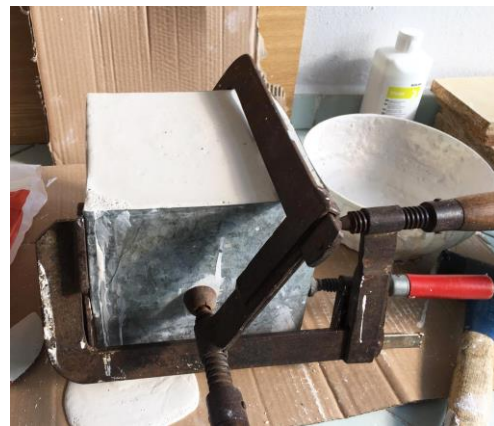
Obr. 128 Zpevnění formy svorkami
