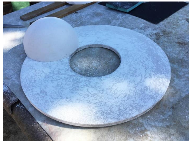
Obr. 140, Obr. 141 Broušení polokoulí na brusném kameni
