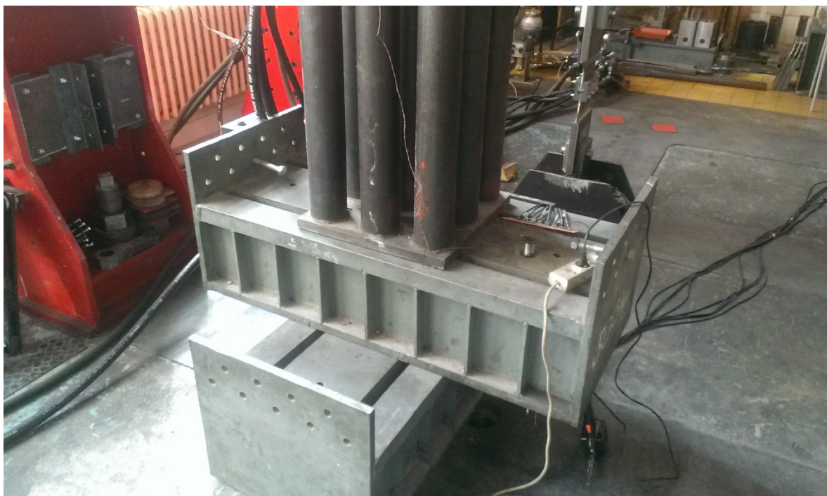
Obr. 8. 1. 2 Tuhé ocelové podložení
