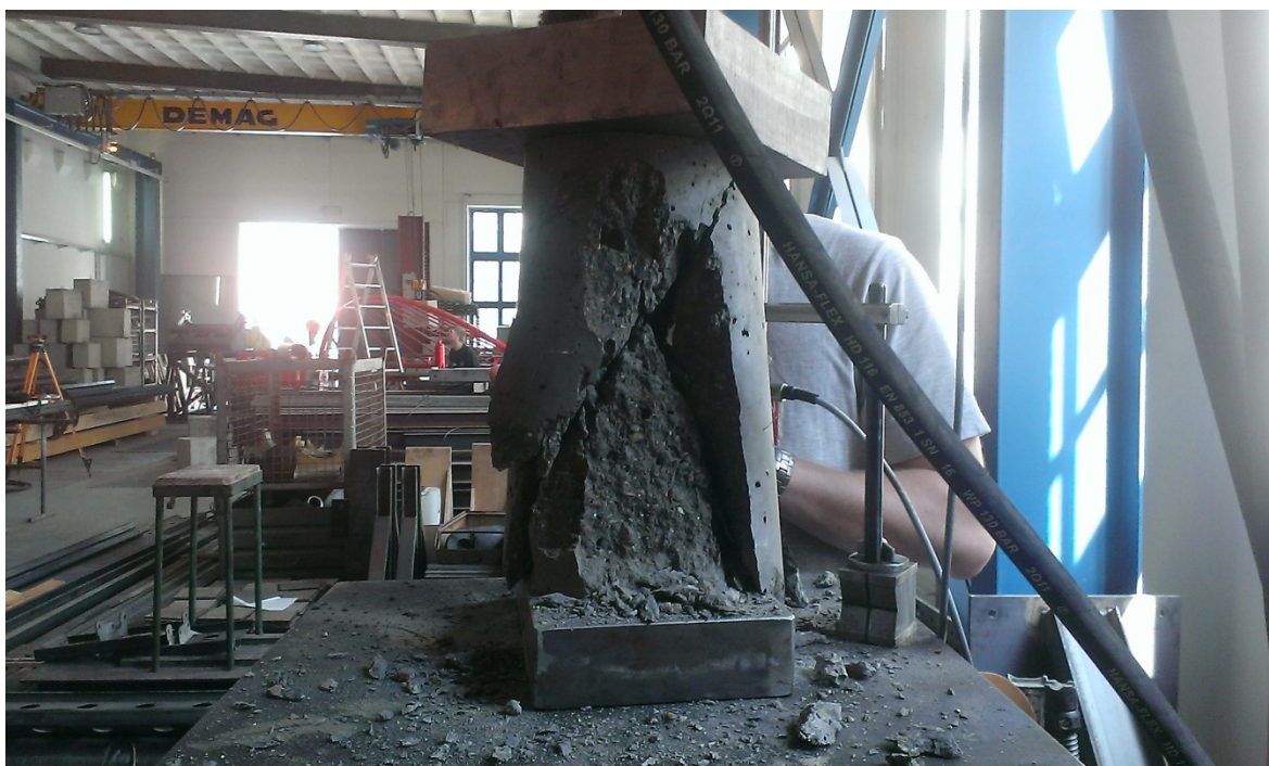
Obr. 8. 1. 4 Porušený betonový zkušební válec
