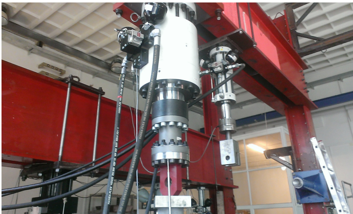
Obr. 8. 1. 3 Zkušební přístroj, který vyvíjel tlakové namáhání
