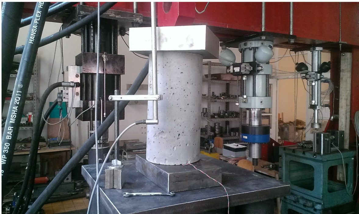
Obr. 8. 1. 1 Betonový zkušební válec mezi ocelovými deskami
