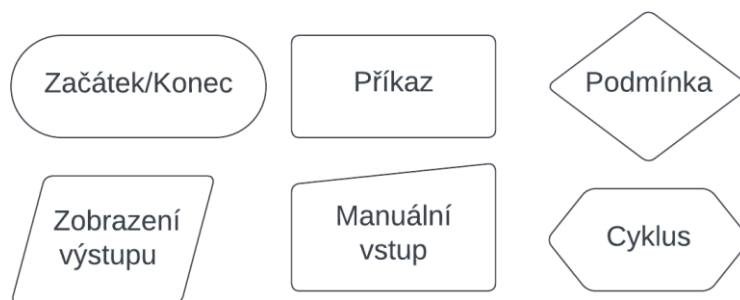
Obrázek 6: Vybrané značky vývojového diagramu (Zdroj: Vlastní zpracování podle [25])
