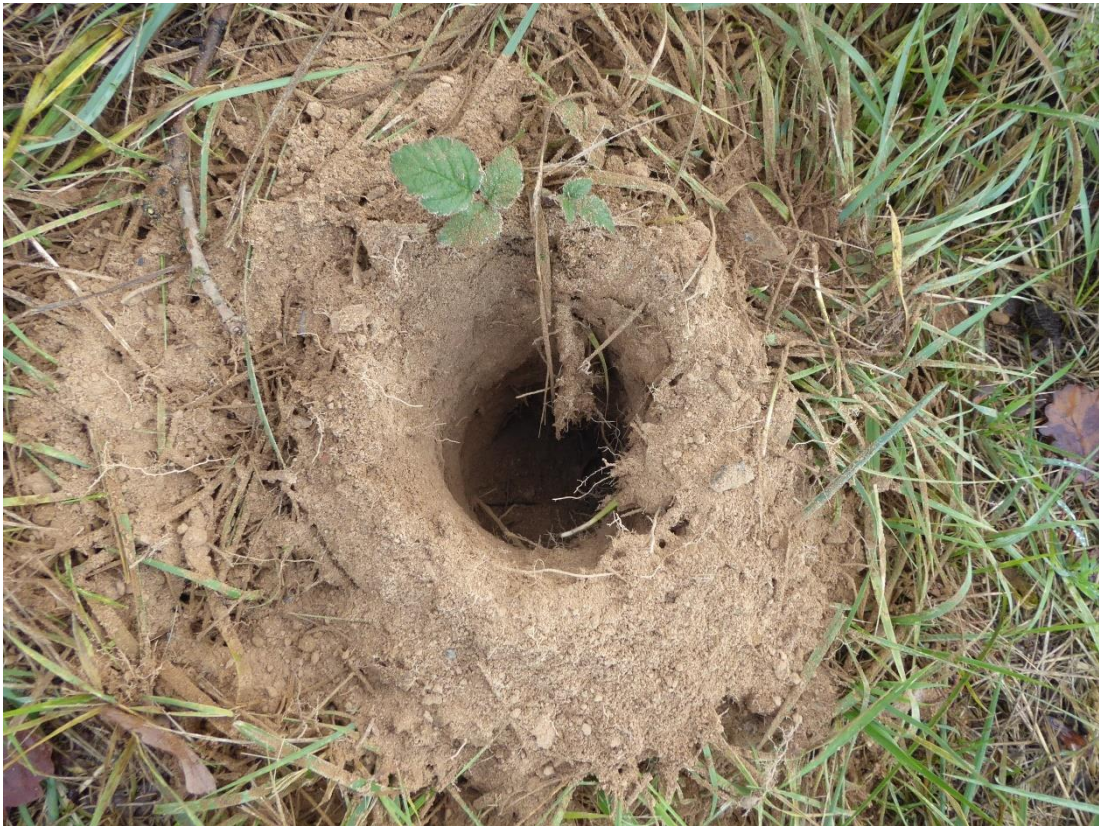
Obrázek 5: Fotografie zachycující vytvořenou jamku pro výsadbu, ze které docházelo i k odběru pedologické sondy sběrem smíšeného vzorku z hloubky půdy 0–20 cm. Foto: Martin Baláš
