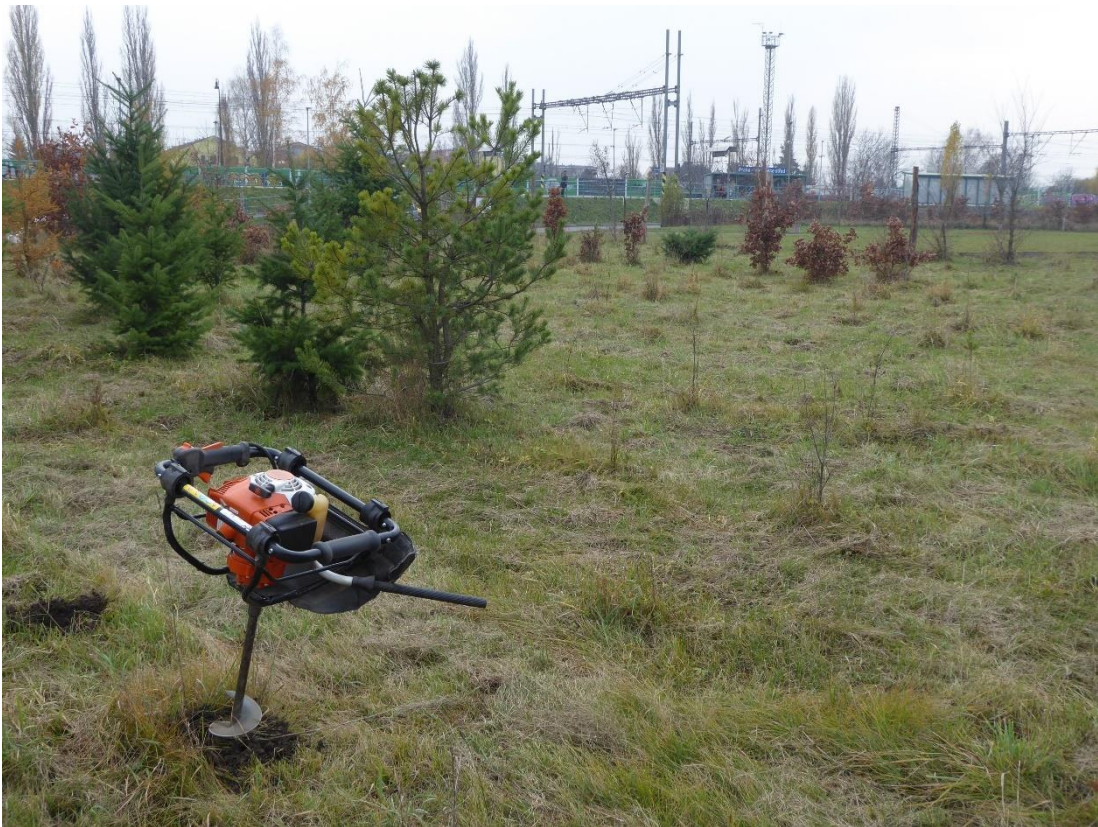
Obrázek 3: Výsadba na výzkumné lokalitě byla provedena pomocí motorového jamkovače s vrtákem. Foto: Martin Baláš
