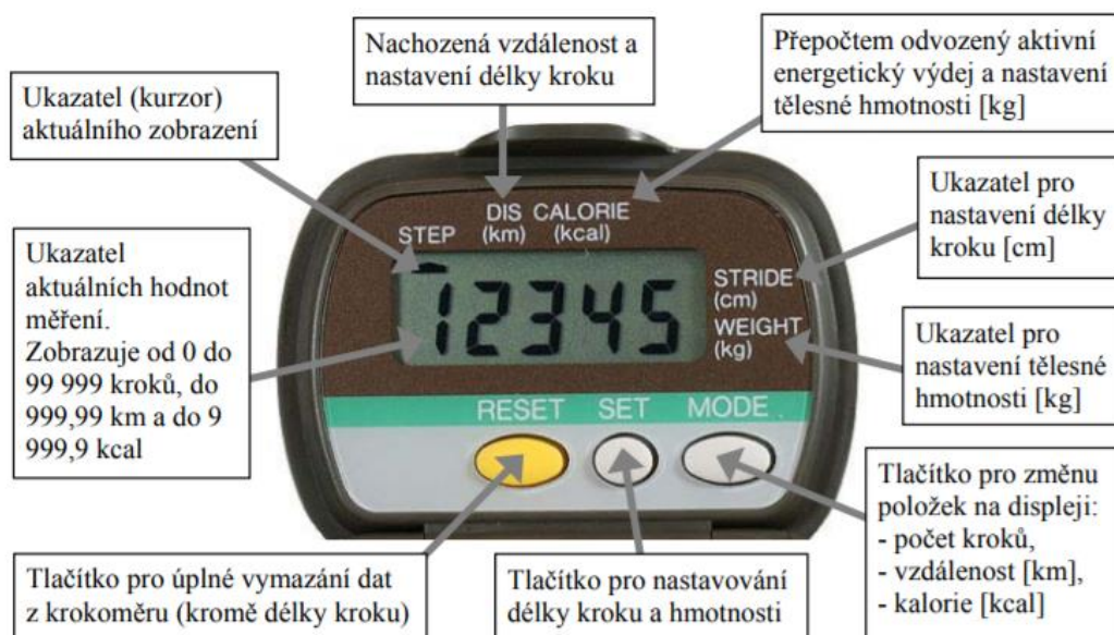
Obrázek 5. Displej pedometru Yamax Digiwalker SW-700 s popisem ovládacích prvků (převzato od Sigmunda, 2012, 13)
