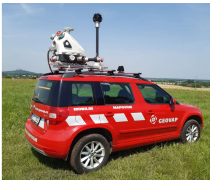
Obr. č. 4: Systém pro mobilní mapování RIEGL na autě firmy GEOVAP [9]
