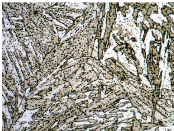
Obr. 4.10 Bainitická struktura oceli 15 313 před započítím experimentů, 2% Nital, měřítko vlevo 20 μm, vpravo 10 μm.
