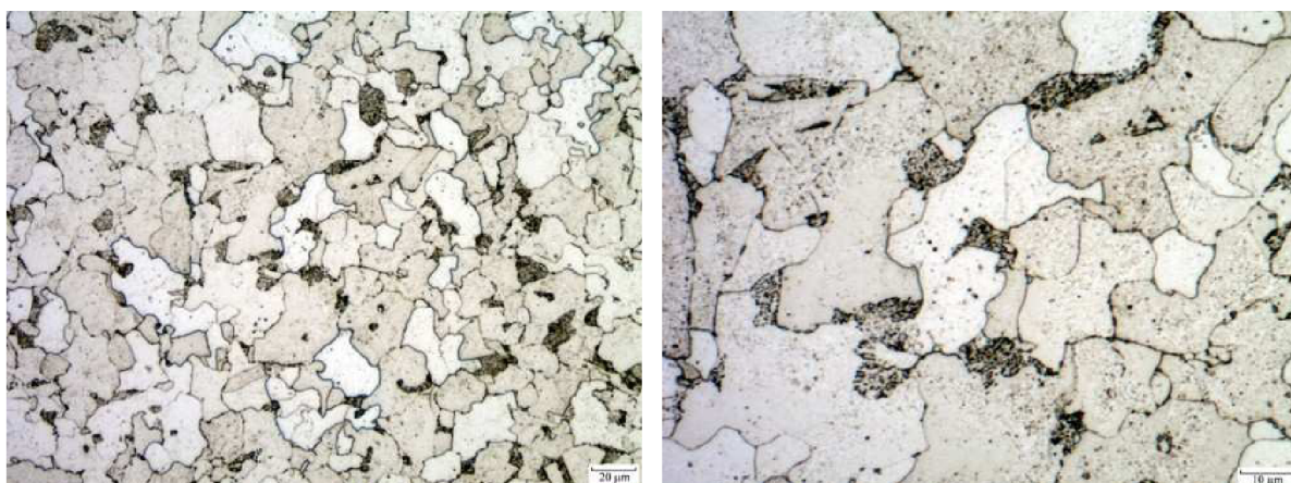
Obr. 4.3 Bainiticko-feritická struktura oceli 15 128 před započítáním experimentů, 2% Nital, měřítko vlevo 20 µm, vpravo 10 µm.
