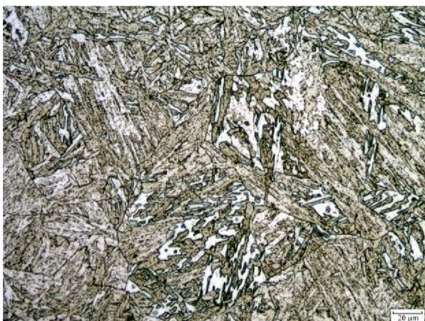
Obr. 4.10 Bainitická struktura oceli 15 313 před započítím experimentů, 2% Nital, měřítko vlevo 20 μm, vpravo 10 μm.
