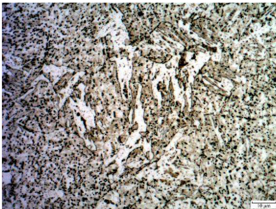
Obr. 4.13 Bainitická struktura oceli 15 313 vzorku č.8 (575°C/320h), 2% Nital, vlevo světelná mikroskopie, vpravo REM, měřítko 10 µm.
