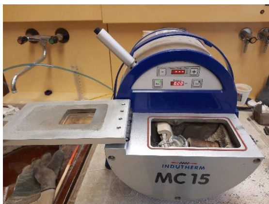
Obrázek 6: Vakuová indukční pec INDUTHERM MC 15
