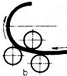
Obr. 77 Valcový stroj na postupné ohýbanie (ksp.tul 2005)
