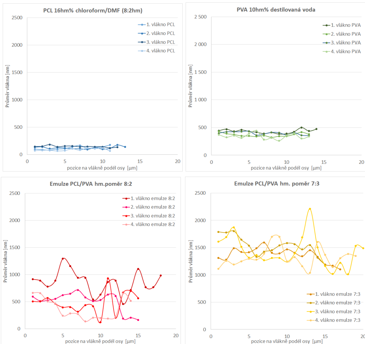
Obrázek 28: Grafy průměrů vláken vytvořených z roztoků PCL (vlevo nahoře) a PVA (vpravo nahoře) a z emulzí těchto roztoků v poměrech 8:2 (vlevo dole) a 7:3 (vpravo dole).
