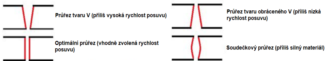
Obr. 11 Tvary průřezů v závislosti na rychlosti posuvu řezací hlavy [23]
