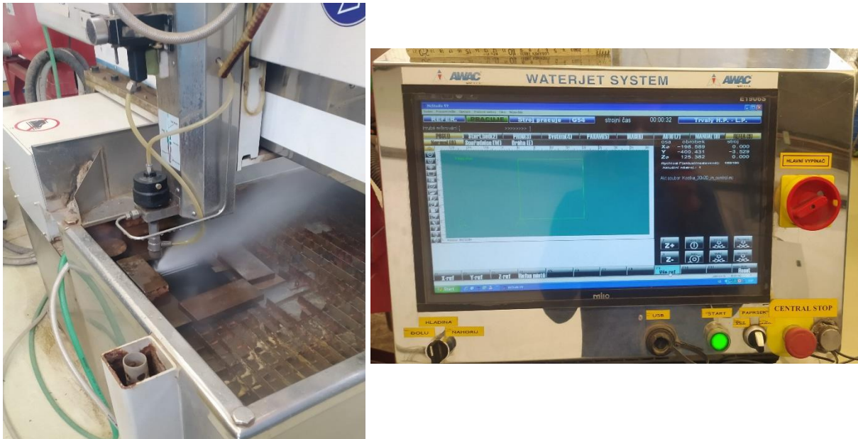
Obr. 19 Zařízení pro dělení vodním paprskem AWAC CNC AWJ CT 0806 [Zdroj: vlastní]
