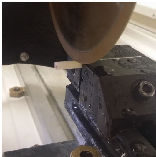
Obrázok 11 Úprava vzorky na konečnú dĺžku
