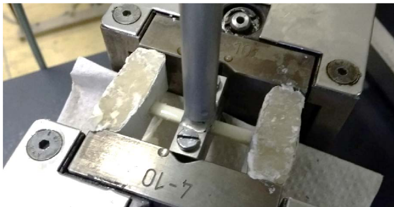
Obrázok 16 Realizácia obojstranného votknutia
