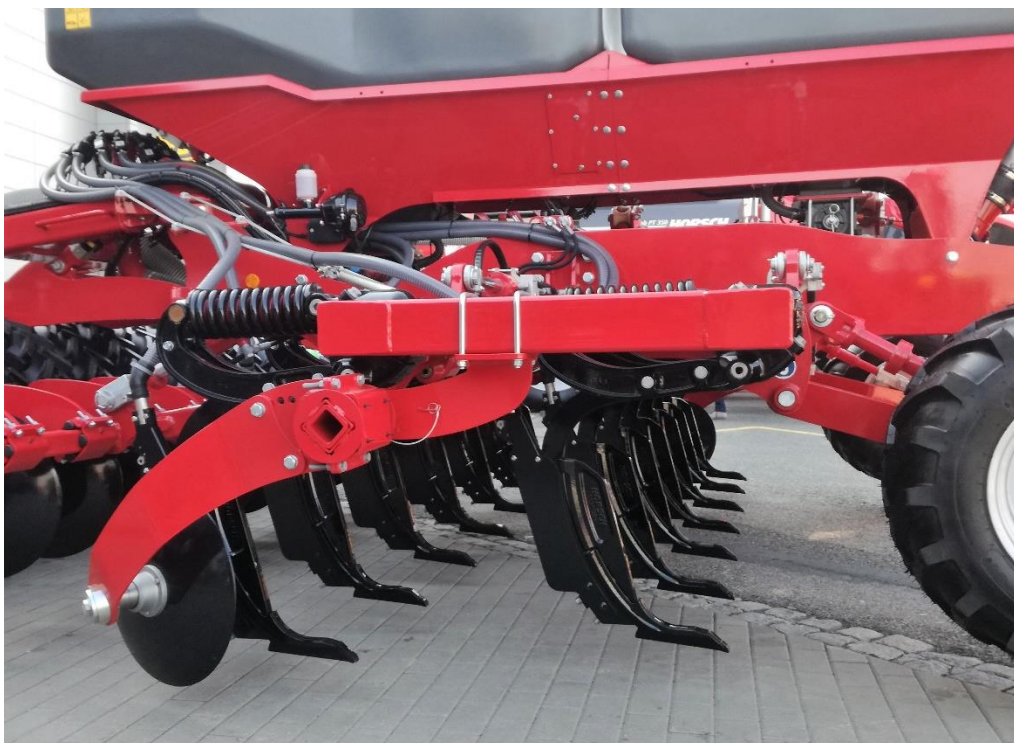
Príloha 10: Sekce radliček u secího stroje Focus TD od firmy HORSCH (Zdroj: vlastní)
