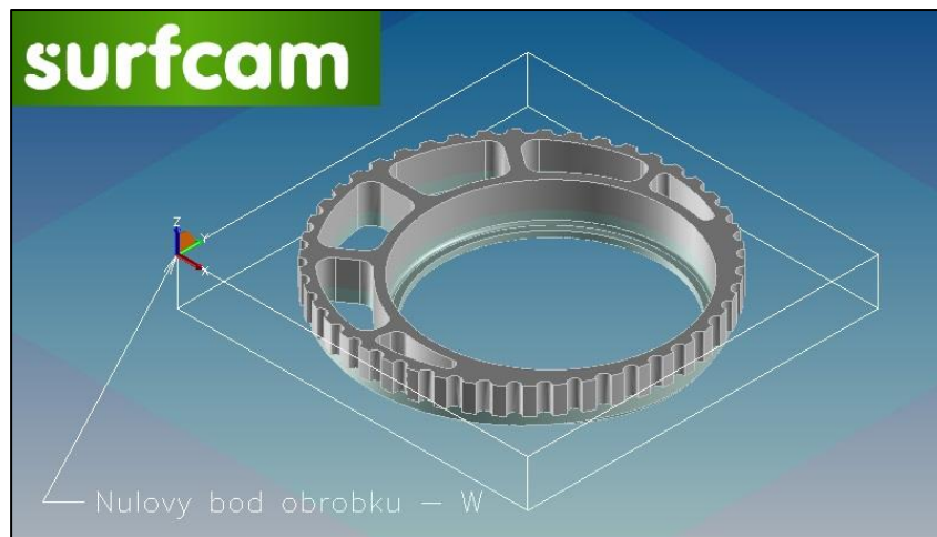
Obr. 10: Polotovar s pravidelným hranatým tvarem [autor]
