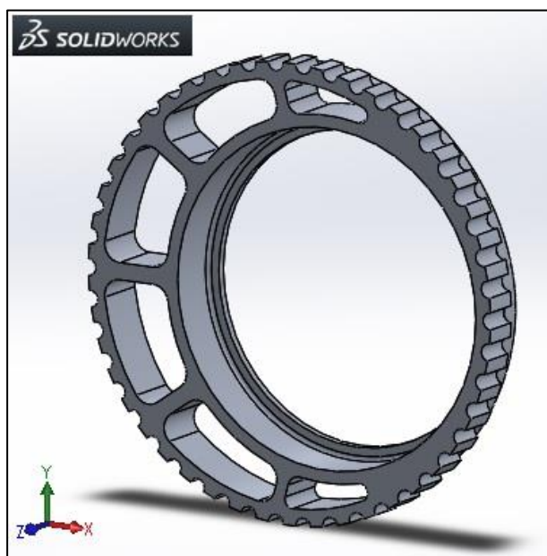
Obr. 9: Model CAD – excentrický držák diferenciálu [autor]
