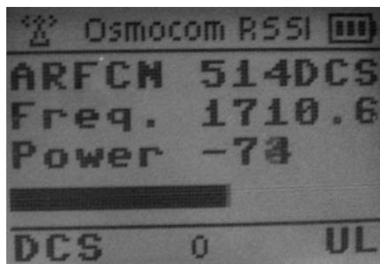
Obr. 4.2: Úroveň signálu směru uplink
