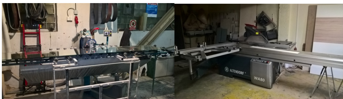
Obr. č. 21 Bruska na skla (zdroj: firma D), Obr. č. 22 Koutoučová pila Altendorf (zdroj: firma D)
