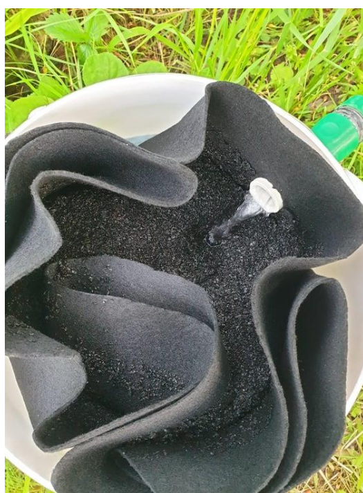
Obr. 5-4 Kýbl opatřený netkanou textílií a naplněn jemnou frakcí černého uhlí
